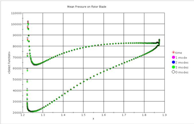
**FIGURE 5.** MEAN PRESSURE DISTRIBUTION ON THE ROTOR.
