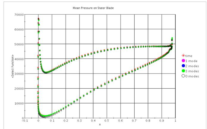
**FIGURE 4.** MEAN PRESSURE DISTRIBUTION ON THE STATOR.
